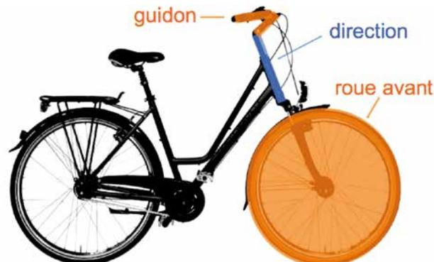
**Indicateur** : Si le guidon bouge indépendamment de la roue avant, la direction doit être réglée et serrée.
