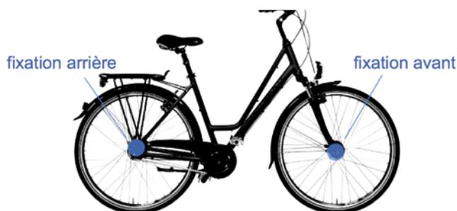
**Indicateur** : Si la roue est bien fixée, il ne doit pas y avoir de mouvement par rapport au cadre du vélo.
